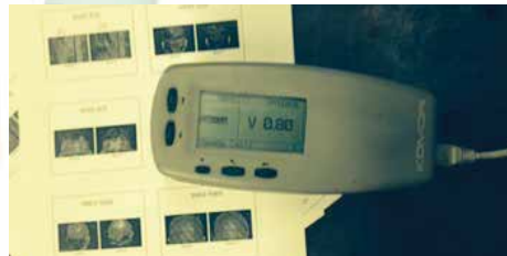
● X - 라이트 (530) 밀도계로 측정 근접 사진 (Instrumental Measurement by Densitometer in outsourcing service)
